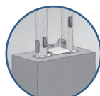
Sabot de réception avant et arrière (autoportant)
