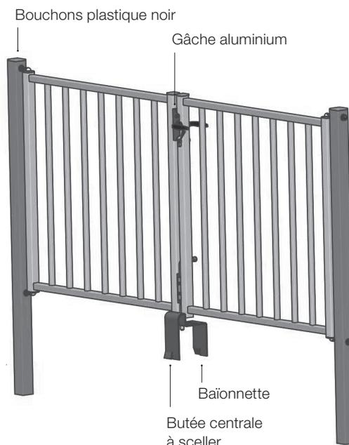
Inversion du sens d'ouverture possible en changeant le montage de la gâche et en retournant le pêne demi-tour de la serrure (nécessite le démontage de la serrure)
