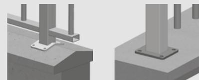
Platine soudée sur couverture 2 pentes
