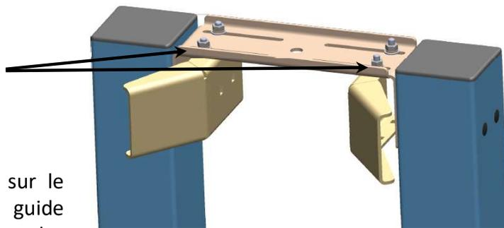
2 - Une fois le vantail posé sur le Rail, les 2 portiques posés et les accessoires réglés, il reste la pose de la butée arrière.
