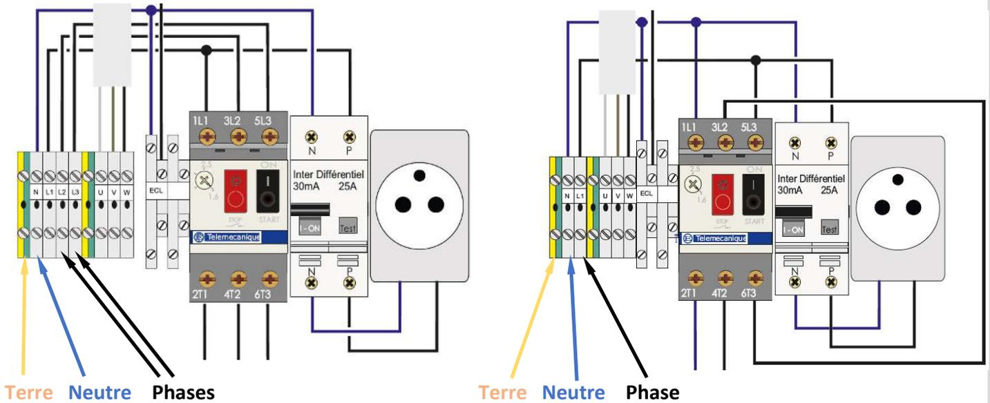
Raccordez l'arrivée électrique sur le bornier de connexions déporté. Celui-ci évite de câbler des éléments dans le coffret de la carte de commande.
