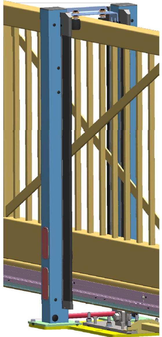
Utiliser des connecteurs rapides pour brancher les barres palpeuses du 2<sup>ème</sup> portique.
