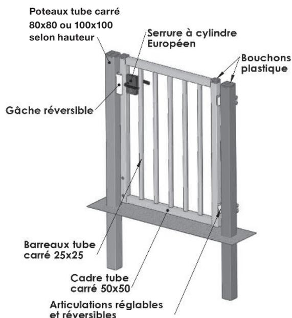
Possibilité de changer le sens d'ouverture en inversant le montage de la gâche sur le poteau ainsi que le sens de montage des plaques vissées sur le vantail.
